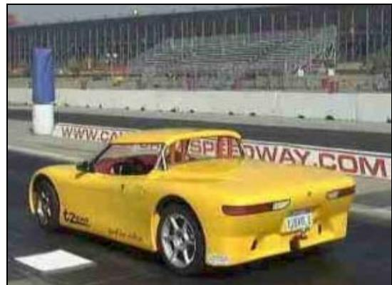
Der T-Zero von AC Propulsion, USA hat bei Testfahren am 9.9.03 Beschleunigungen in 3,6 - 3,7 s von 0 bis 60 mph erreicht. Am 3.10.03 wurden bei ein Langstreckentest 302 Meilen (!) bei einer Durchschnittsgeschwindigkeit von 57,1 mph. erreicht. Entnommen wurden 130 Ah, verbraucht wurden 160 Wh pro Meile.
