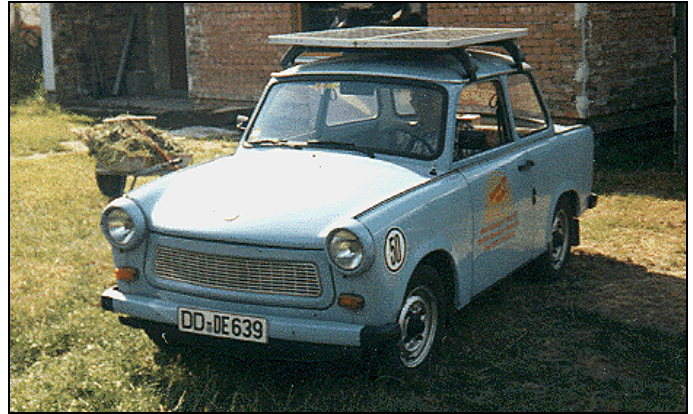
Trabi aus Dresden mit 200 Watt Solardach
