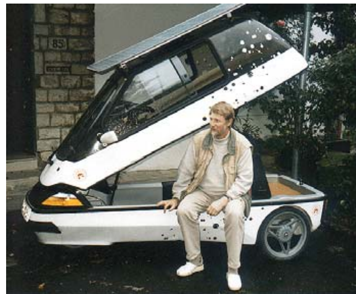
City EL, Bj. 1990, ca. 10.000 km, Blei-Vlies Akkus, Reichweite 40 bis 60 km, 45 km/h Höchstgeschwindigkeit Solarmodul 100 W auf dem Fahrzeug für ca. 10 km rein solar pro Tag
