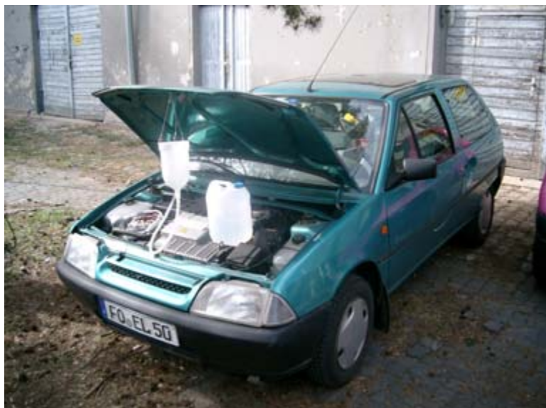
Citroen AX électrique, Bj. 1996, ca. 50.000 km, Ni-Cd Akkus, Reichweite 70 bis 120 km, 95 km/h Höchstgeschwindigkeit (hier bei Nachfüllen von dest. Wasser für die Akkus) Stromversorgung: Solaranlage 4 kW auf dem Hausdach
