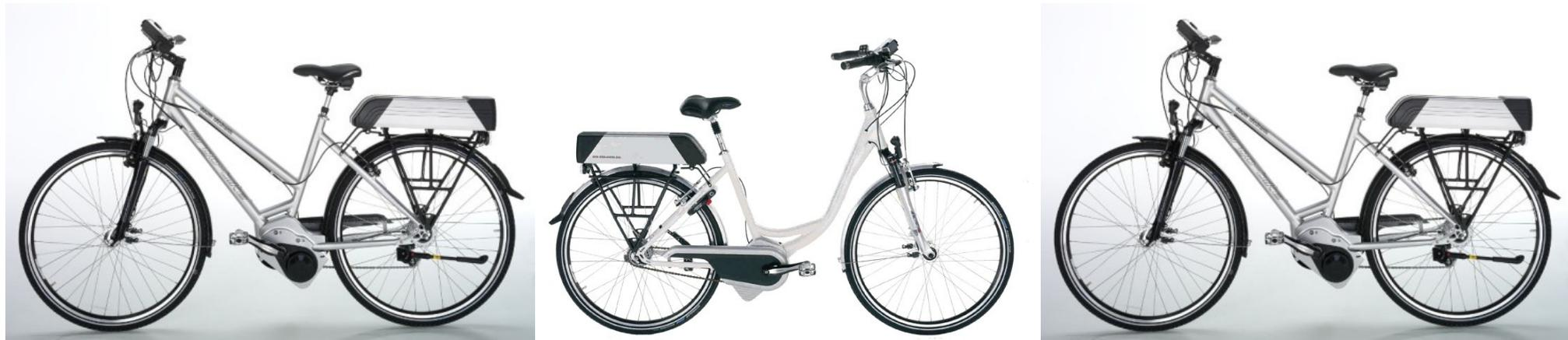
**Der Elektroantrieb arbeitet über die Kette und die 7-Gang-Nabenschaltung auf das Hinterrad. Das hat Vorteile gegenüber die häufig anzutreffenden Radnabenmotoren besonders bei Steigungen: höhere Steigfähigkeit bei niedrigeren Strömen. Das wirkt sich positiv auf höhere Reichweiten aus. Die Pedelecs werden in Deutschland gefertigt.**
