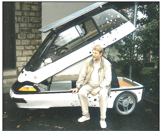
City-El des Autors mit „Flächenantenne“ auf dem Fahrzeugdach für die Aufnahme der Energie vom „Funkprovider“
