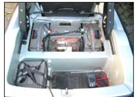
Dann zog ich das Netzwerkkabel durch den Kabelkanal zwischen Batterien und Sitz und befestigte die Kabel an einer 8-poligen Lüsterklemme, die ich zunächst unter dem Sitz herausragen lasse. Das an-
