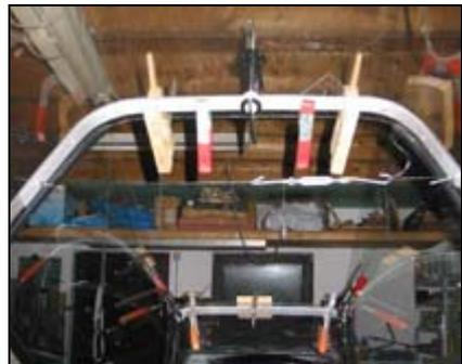
Zwingen und 2 Klammern sowie 3 Schrauben halten die Bügel bis zur Aushärtung des Klebers
