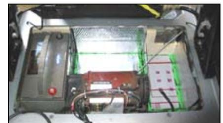
Links ist der Akku schon eingebaut, in der Mitte sieht man die Isolierfolie, und rechts ist die Heiz-Packung zu erkennen.
