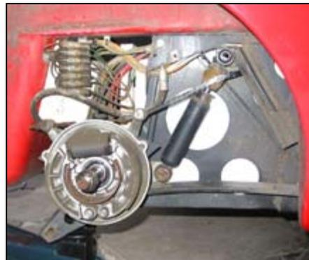
Auf dem nächsten Bild ist der Dämpfer umgedreht montiert. Achtung! Die Scheiben nicht verlieren und genauso wieder aufstecken. Man kann gleich den Zustand der Bremsen und des Handbremsseiles kontrollieren und den Dämpferhals mit Silikonöl einsprühen.
