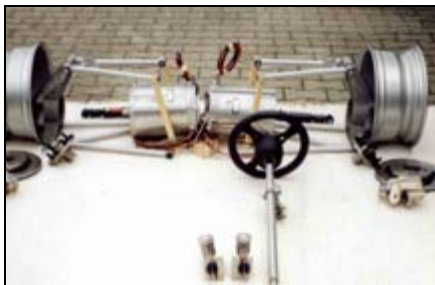
Die Hinterachse mit den zwei Motoren
