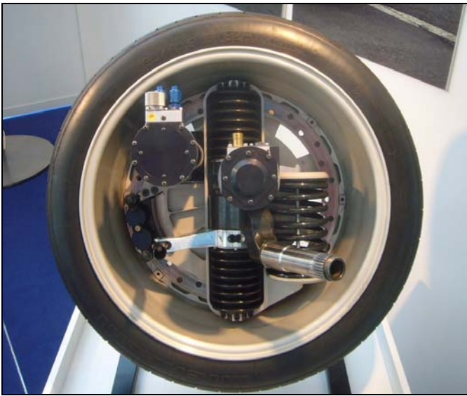
Michelin's „active wheel“ mit Antrieb, Federung und Bremsen
