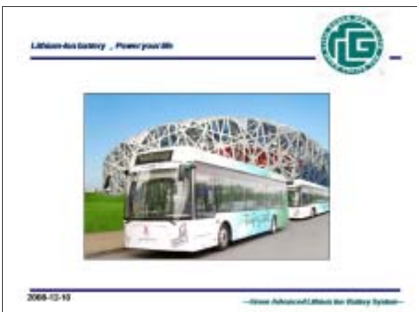
Deutlich erkennt man den Dachaufbau für die Batterien
