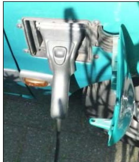
PSA Ladeklappe (geöffnet)
