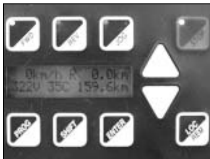
159.6 km mit einer Batterieladung bei einer durchschnittlichen Geschwindigkeit von rund 55km/h
