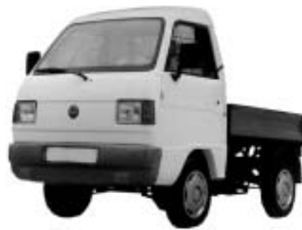
Der „Trans“, entweder mit Diesel oder Elektroantrieb (4 kW, bis 45 km/h)
