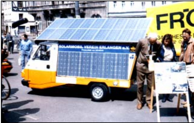
Vespa Piaggio Mobil, Kleinlieferwagen, 600 Watt solar
