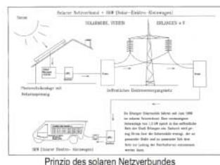
Prinzip des solaren Netzverbundes
