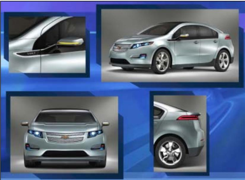
Der GM Volt wird einer der ersten seriellen Hybridfahrzeuge sein, d.h. der Antrieb ist immer elektrisch und der Benzinmotor mit Generator lädt bei Bedarf im Betrieb die Batterien nach. Die ersten Fahrzeuge von GM sind für 2010 angekündigt, und später wird auch Opel diese Technik anbieten.
