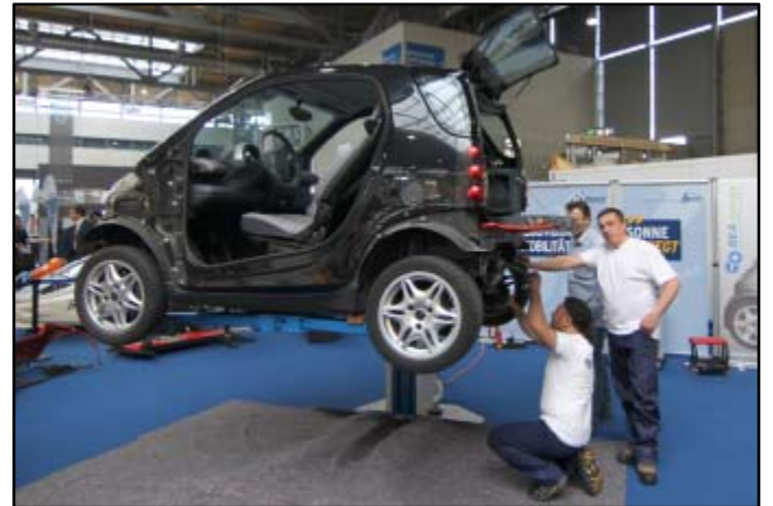
Die Umbauaktion: Bea-Tricks und First Mobility bauten life auf der Messe den Benzinmotor aus und einen Elektroantrieb ein, komplett mit Steuerung, Akkus usw. Am ersten Messetag fuhr der Wagen mit Benzinmotor ein, am letzten Tag sollte er elektrisch fahren. War das zu schaffen?
