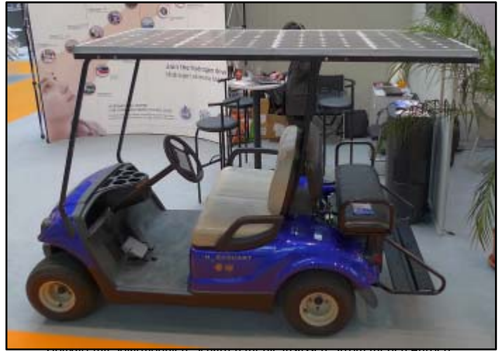
Golfkarte mit Solarmodulen: Schutz für die Insassen, Strom für den Antrieb
