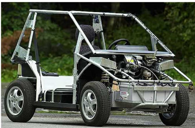
Der Stahlrohrrahmen des damaligen KEWET
