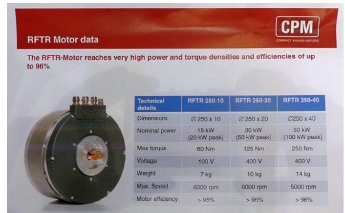
Der „Supermotor“ von CPM in natura und im Bild mit beeindruckenden Werten. Noch sind es Muster, die Serienfertigung könnte beginnen – wenn Bestellungen für Stückzahlen eingehen würden. CPM zeigte kleinere Motoren z.B. für die Govecs Roller und andere Zweiräder sowie für die Torqeedo Aussenborder für Elektroboote.
