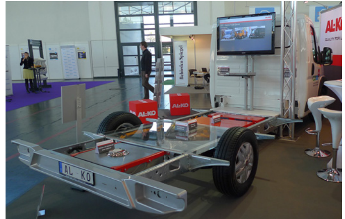
Alko kauft praktisch nur Teilfahrzeuge. Der gesamte hintere Teil mit dem Elektroantrieb wird selbst gefertigt. Auf Wunsch kann man sich hier sein Traum-Campingwagen bauen lassen.
