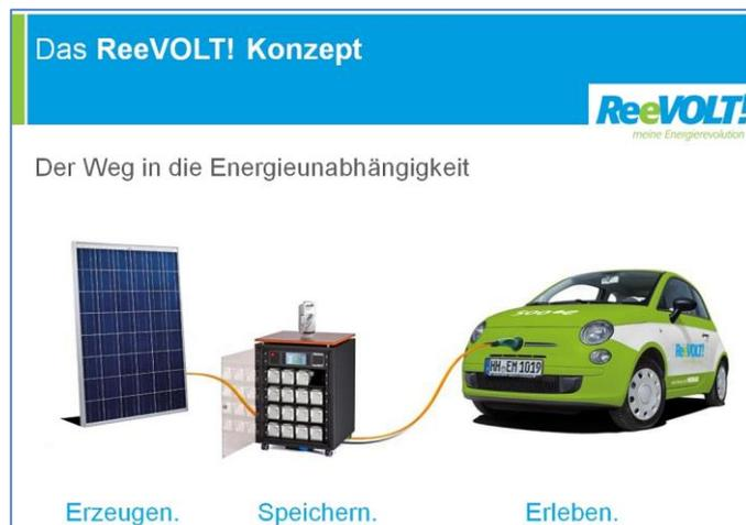
Die Hauspeicher basierend auf einer Box zur Aufnahme von „second life“ Akkus der Flyer Pedelecs wurde bereits im vergangenen Jahr vorgestellt. Hier wird das mögliche Zusammenspiel mit der Photovoltaik und dem Elektroauto gezeigt.
