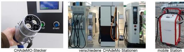
Der Chademo Stecker ist größer und überträgt Gleichstrom. Das eigentliche Ladegerät - das für 20 bis 50 kW teuer und schwer ist - wird nicht im Auto mitgeführt sondern steht stationär in der Stromtankstelle zur Verfügung. Übertragen wird direkt Gleichstrom und nur über eine Diode auf den Fahrzeugakk geleitet. Vom Fahrzeugakku werden über integrierte Datenleitungen die zur Ladesteuerung nötigen Daten ans Ladegerät geleitet.
