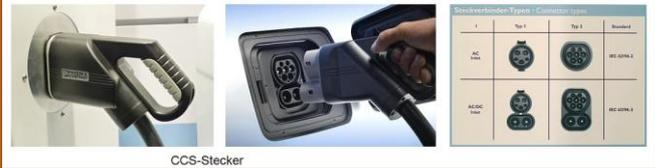
Der CCS Stecker ist eine Ergänzung des Typ2 Steckers um Gleichstromkontakte, die Idee und Steuerung funktioniert ähnlich wie bei Chademo.
