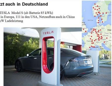
Der TESLA Model S hat am Fahrzeug eine Typ2 Dose. Der TESLA Supercharger hat ein fest angeschlossenes Kabel, das ins Fahrzeug eingesteckt wird, und zwar in dieselbe Dose, über die auch AC Ladung bis 22 kW läuft. Über die Datenleitungen wird sichergestellt, dass sowohl bei Gleichstrom bis 120 kW als auch bei Drehstrom bis 22 kW oder sogar einphasig alles korrekt abläuft.
