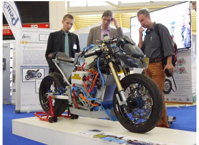
Weitere Einblicke in den Fahrzeugbau erlaubte das GAUSS Motorrad der Hochschule Darmstadt. Das Vorderrad ist durch Gelenkwellen mit der Antriebsmaschine gekoppelt, so kann auch das Vorderrad zum Rekuperieren genutzt werden. (Foto: © bsm, Quelle www.bsm-ev.de)
