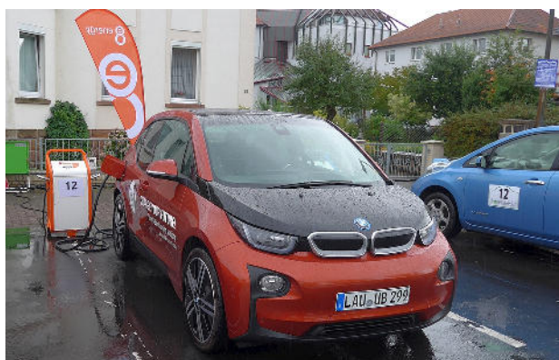
Kurz vor der Abfahrt aus Schwalmstadt noch Aufladen an der mobilen 20 kW CCS Station, die nur für die Veranstaltung installiert war.
