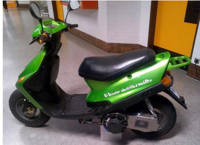
Der Roller nach dem Umbau auf Elektroantrieb. Man erkennt den Perm Motor und die neue Schwinge.
