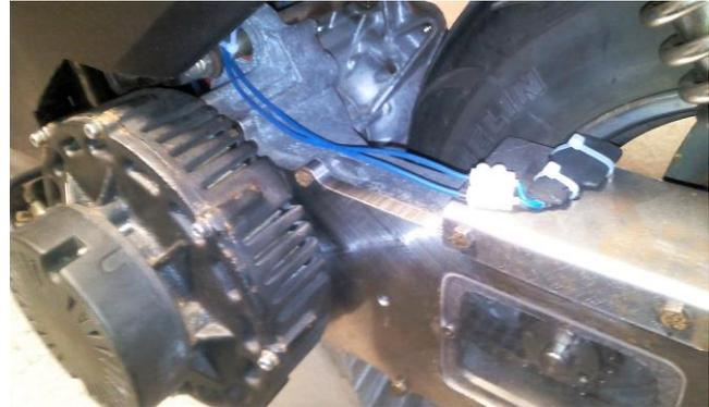
Unten links fällt der Elektromotor auf, der ein wenig nach außen übersteht. Es ist der oben erwähnte Gleichstrom-Scheibenläufer.
