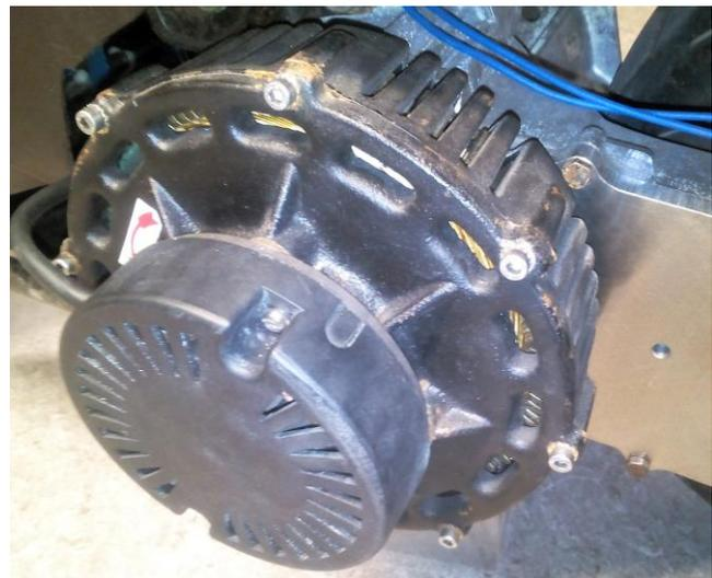
Der Perm Motor nach dem Einbau
