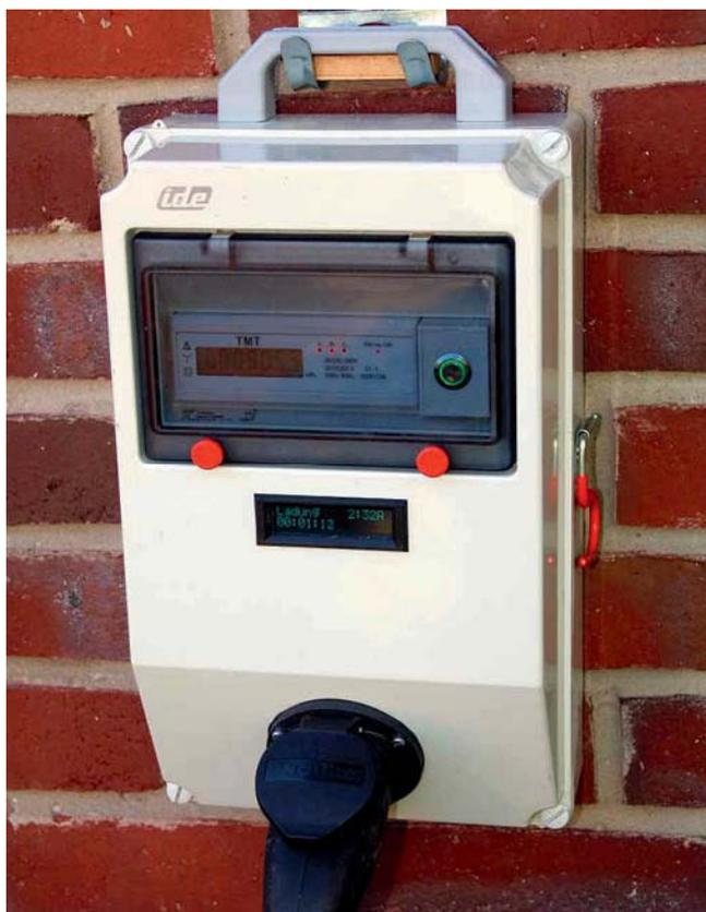
Meine mobile Ladebox ist in einem spritzwassergeschützten Gehäuse untergebracht. Am Griff kann die Box transportiert oder auch aufgehängt werden. An der Seite ist eine Halterung, in der das CEE-Kabel eingehängt werden kann.
