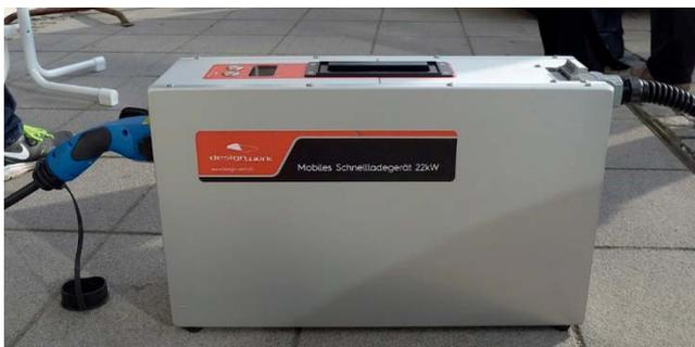
Das mobile DC Schnellladegerät vom Designwerk aus der Schweiz, Eingang: AC über CEE-Drehstromstecker oder Typ2 Anschluss, Ausgang: DC über Chademo oder CCS
