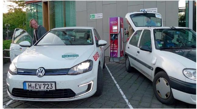
Laden in Berlin am Triple Charger. CCS war kein Problem, aber mit einem TYP2 Stecker an der Ladesäule ging nichts, da am Auto ein Kabel mit-Steckverbindung für eine herkömmliche Typ2 Station (bis 22kW) fest installiert war. Bei 43kW braucht man die Ladebuchse am Auto
