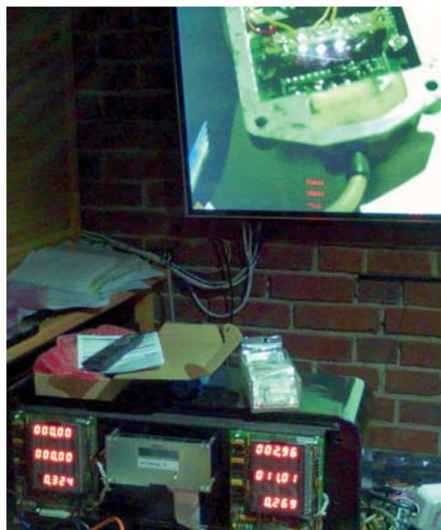
Um z.B. zwei ZOE optimal laden zu können, wird ein Lastmanagement eingesetzt. Sollte ein Zoe nicht mehr die volle Leistung benötigen, dann steht die Differenz am zweiten Ausgang zur Verfügung. Die Steuereinheiten kommunizieren mit den Zählern.
