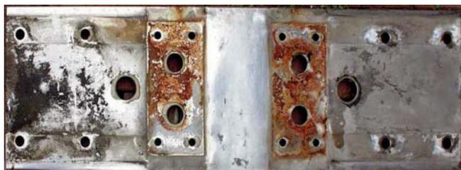
Während der Rahmen des Pumpenraums gesandstrahlt wurde, wurde das Rechenwerk aus seinem Rahmen entfernt. Und dann waren da noch die Edelstahlbleche. Besonders das Blech, das die Oberfläche zum Pumpenraum abschließt sieht schlimm aus.
