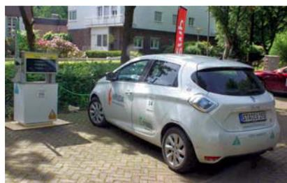
Neuerungen eingebaut. So hat die Säule nun einen WLAN-Anschluß mit dem man per Laptop in die Wartung eingreifen kann. Nebenbei kann man sich darüber auch die Ladediagramme der erfolgten Ladungen anzeigen lassen.
