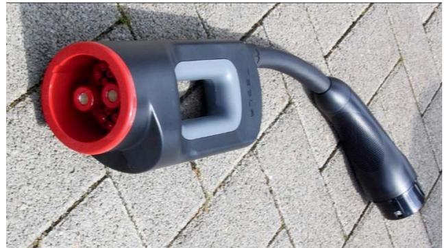
Die TESLA Model S können mit diesem Adapter auch an Chademo DC Schnelllader bis 50 kW laden.
