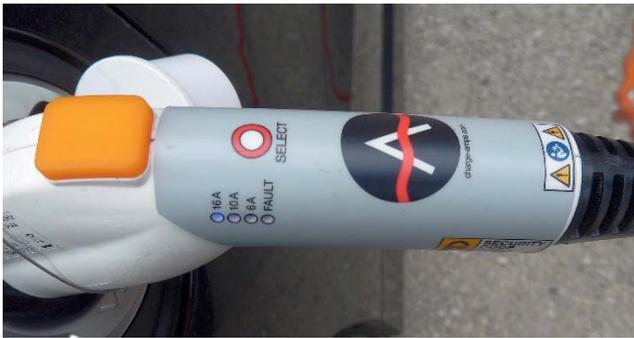
Typ1 Ladestecker (am Auto) mit eingebauten ICCB zum Laden 230V bis 16A, siehe [www.charge-amps.com](http://www.charge-amps.com)
