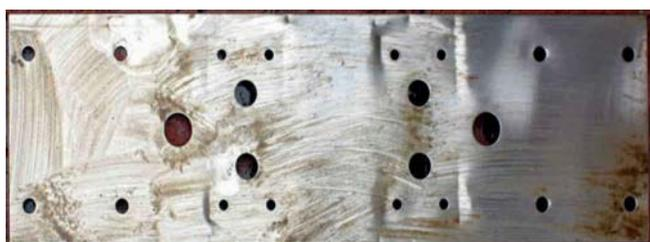
Rost und Schmutz, Klebereste usw. mussten entfernt werden. Tja, und wie bekommt man das weg? Ein Tipp: mit Essig. Ein anderer Tipp: Sandstrahlen. Und dann noch: Schleifpapier.
