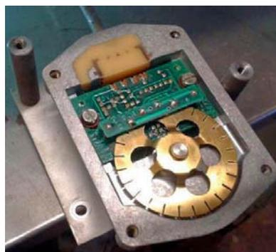
Zur Auswertung werden die Dunkelphasen der Scheibe herangezogen. D.h. grundsätzlich müssen immer 3 Fotodioden ein Signal bekommen. Sollten weniger als 3 Fotodioden ein Signal bekommen, dann liefert der Impulsgeber ein Störungssignal (Z.B. bei Ausfall einer LED).
