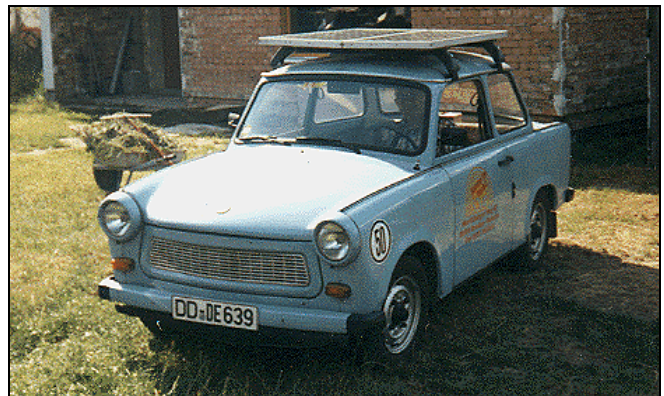
Trabi aus Dresden mit 200 Watt Solardach
