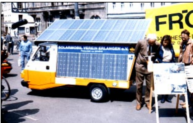
Vespa Piaggio Mobil, Kleinlieferwagen mit fast 600 Watt solar auf dem Dach und den Seiten
