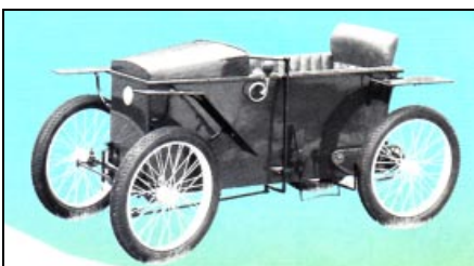
Slaby-Beringer, Berlin, 1920, einsitziges Elektroleichtfahrzeug, 180 kg
