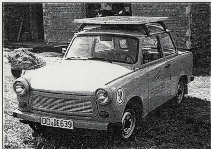
Der „neue“ Trabi mit den zwei BP-Solarmodulen auf dem Dach
