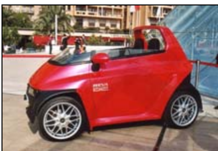
Erstmals öffentlich präsentiert: der neue REVA mit Drehstromantrieb und ZEBRA Batterie, made in Bangalore (Indien).
