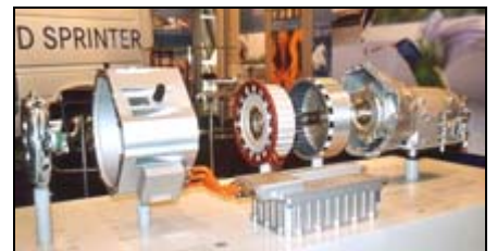
Elektrischer Teil des Hybridantriebes für den DaimlerChrysler Sprinter. Der Sprinter wird vorerst nur für ausgewählte Kunden zur Erprobung angeboten.
