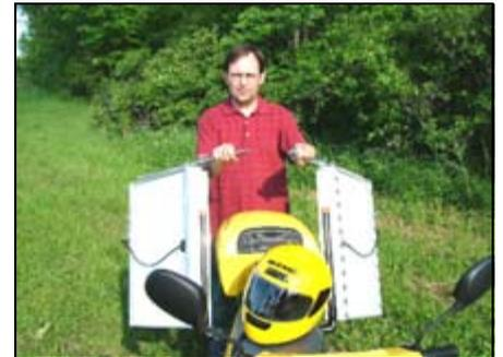
Eine einfache Vorrichtung aus Alu-Streben und zwei Seilhaken dient zum Arretieren der Module in Park-Stellung. Dies verhindert das Einklappen der äußeren Module an windigen Tagen. Ein einfaches Alu-Rohr wird über das Flacheisen geschoben, damit wird die Lade-Stellung arretiert. Das hat sich sogar bei garstigen Windböen bewährt.
