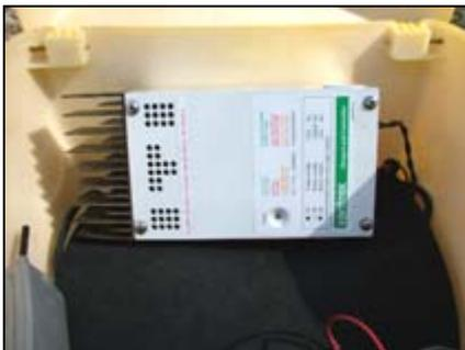
Meine Module hatten eine Leerlaufspannung von etwa 40 Volt an jeder Seite. Mechanisch wurden die Kabel mit Kabelbindern und Isolierfolie gesichert. Die Kabel von den Solarmodulen wurden über extra dafür gebohrt Löcher recht und links vom Kofferraum zum Solar-Laderegler geführt.
