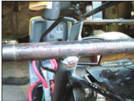
Mit Hilfe von zwei 3/4" Bogen und zwei 45 cm Rohren wurde der Zusammenbau gemacht. Die Teile wurden beim Zusammenschrauben mit Hilfe von Loctite (Permatex) oder ähnlichem gesichert, damit sie sich nicht während der Fahrt lockern. Die senkrechten Rohre wurden so fest wie möglich angezogen und gerade so ausgerichtet, dass sie hinter dem Kofferraum und so hoch sind, dass die Positionslichter nicht verdeckt sind.
