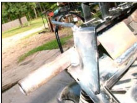
Das Hauptrohr wurde sorgfältig abgemessen, angepasst und nachgemessen. Dann wurde es mit ein paar Schweisspunkten geheftet, genau ausgerichtet und dann endgültig festgeschweisst. Eine Platte ca. 6,5 x 10 cm und 6 mm dick wurde zwischen den Rollerrahmen geschweisst, um ihn oben zusammen zu halten.
