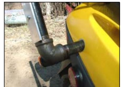
Man soll nur eine Seite auf einmal auseinander nehmen, damit die Löcher in den Rollerteilen so genau wie möglich gemacht werden können. Ich habe ein ca. 46 cm langes 3/4“ Zoll Rohr, an beiden Enden mit Gewinden, mit einem „magic marker“ innen eingeschoben, um zu markieren, wo die Löcher in den Roller gebohrt werden
