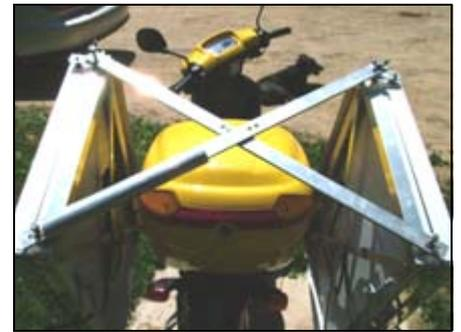
Die Bilder zeigen die Verstrebungen, die an einer Seite mit Flügelmutter befestigt sind. Nach dem Öffnen können sie in Ladestellung geschwenkt werden.
