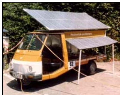
Solare Ladepause mit ausgeklappten Modulen. Wegen der Gewichtsersparnis fuhren wir ohne Türen, angenehm bei der Hitze.
