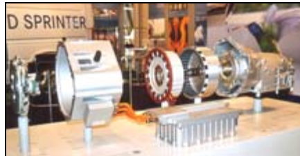
Antriebskomponenten des Hybrid Sprinters (rr)
