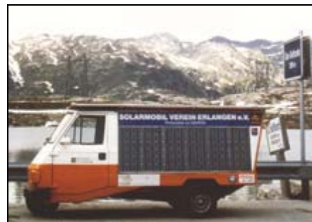
Bild 4: VESPA-Piaggio Kleinlaster, 550 kg Eigengewicht, 550 kg Zuladung, 3,5 m Wendekreis, hier umgebaut zu Deutschlands erstem TÜV-zugelassenem Solarmobil
