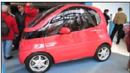
Bild 8: Der Tulip ist ein 2,20 m langes und 1,40 m breites Elektroauto, das per Induktion aufgeladen wird und bis zu 75 km/h schnell ist.
