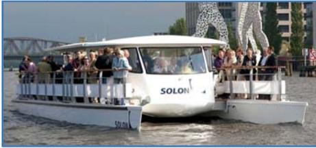
Weitere solare Fahrgastschiffe fahren seit Jahren von der Kopf-Solarschiff GmbH auf der Alster, dem Maschsee, dem Neckar etc. und sorgen für emissionsfreie Mobilität auch auf dem Wasser.
