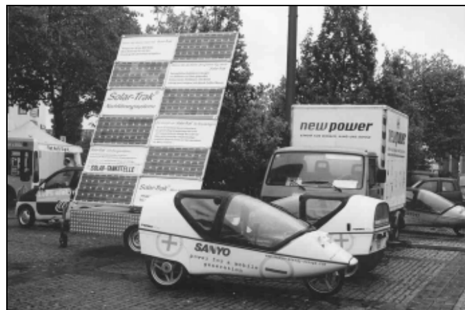
Bei dem niedrigen Energieverbrauch des TWIKE von ca. 5 kWh/100km, lohnt sich auch die Solarstromversorgung (entspricht energetisch etwa 0,5 l Benzin auf 100 km), (EVS18, Oktober 2001 in Berlin)
