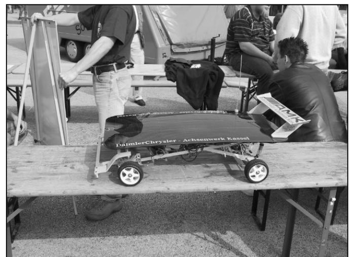
Solarmobil mit dem Standard-Solarmodul auf dem Fahrzeug
